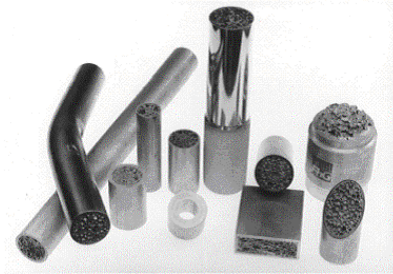
Διάφοροι τύποι σωλήνων και προφίλ γεμισμένων με αφρό αλουμινίου
